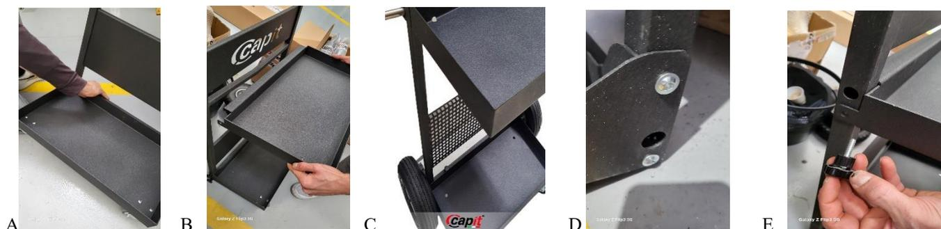
Prendi 2 perni “ruota GOMMA” che hanno già montato i due anelli di fermo ruota (fig. F sotto) inserisci il perno dentro la ruota di gomma, senza dimenticarsi gli anelli (o perni) distanziali (FIG.H). I distanziali o anelli non faranno strisciare la ruota sulla struttura.
